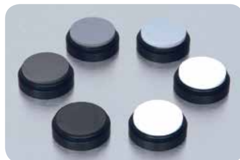
Groupe de normes de référence Labsphere pour un test de linéarité photométrique (selon USP <1119> et Ph. Eur. 2.2.40).
